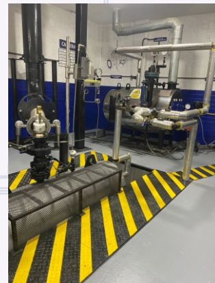
Banco para pruebas vapor y aire modelo 1636
