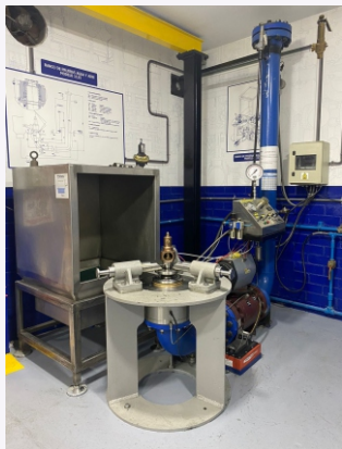
Banco para pruebas agua y aire modelo 1115
