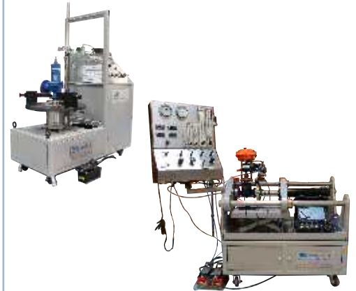
Bancos de Pruebas Seguridad y Control
