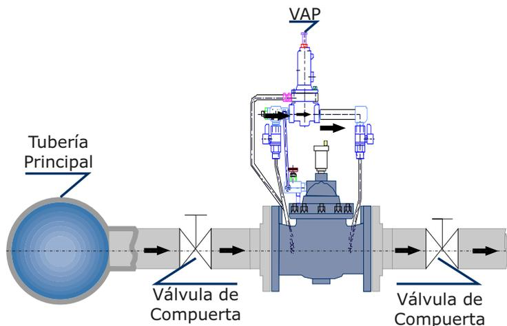
El piloto de alivio sensa la presión a la entrada de la Válvula, abriéndose o cerrándose para abrir o cerrar la Válvula principal una presión determinada. La alta sensibilidad del piloto garantiza un control preciso de la presión máxima, sin ocasionar transientes de presión con aperturas y cierres súbitos.
